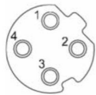
通讯接口 A/B: M12 4PIN socket, D-coded
