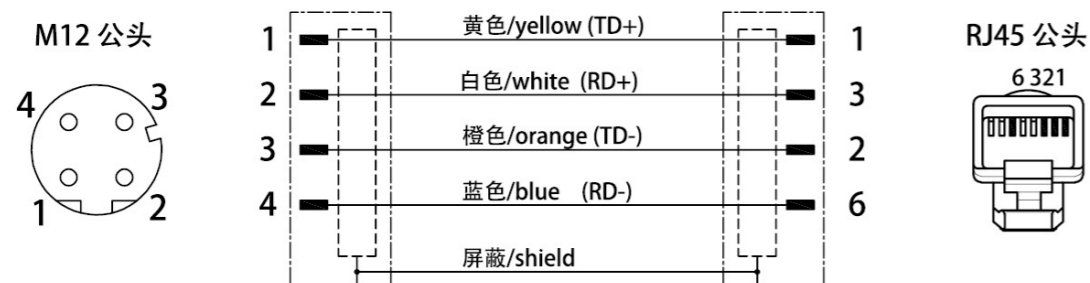
电路图 / Schematic diagram
